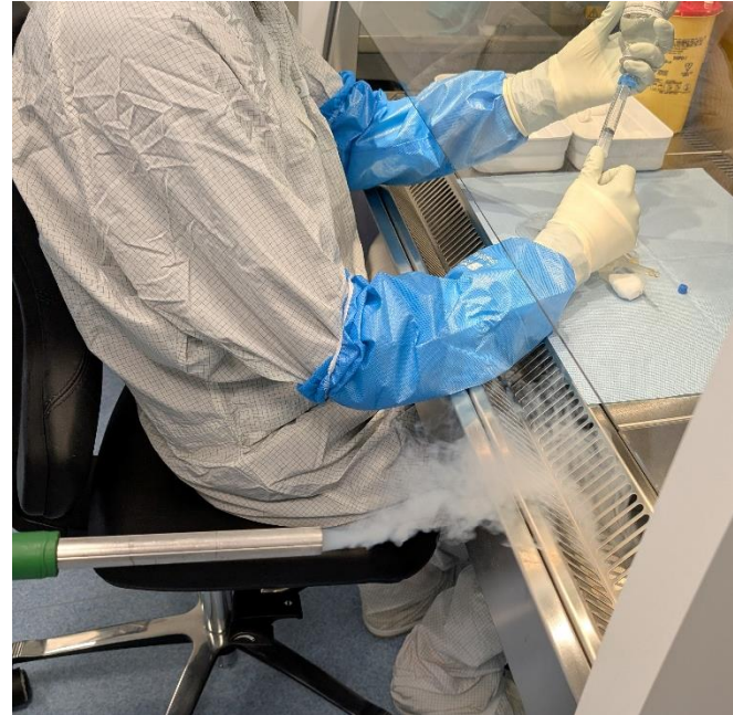
Strömungsvisualisierung (aus der Qualifizierung einer neu angeschafften Werkbank)
