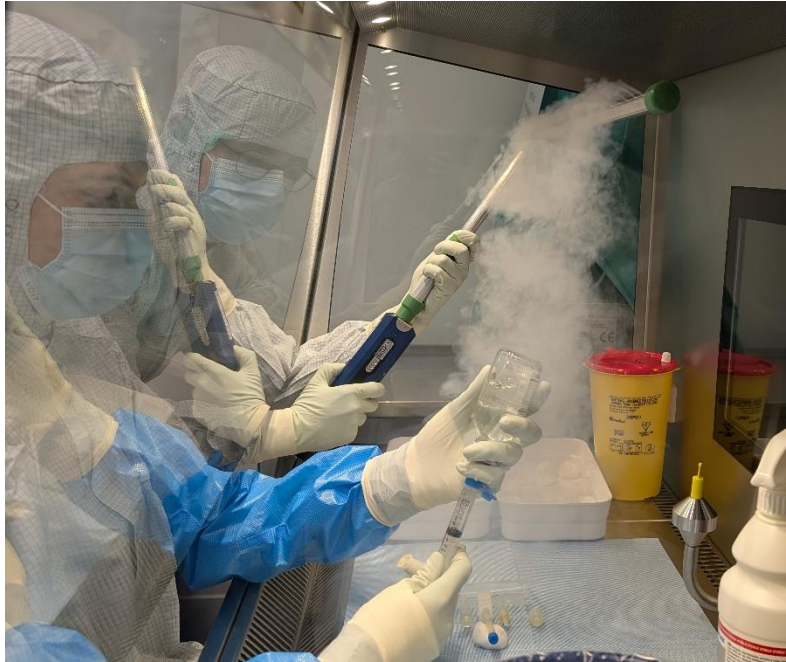
Strömungsvisualisierung (aus der Qualifizierung einer neu angeschafften Werkbank)
